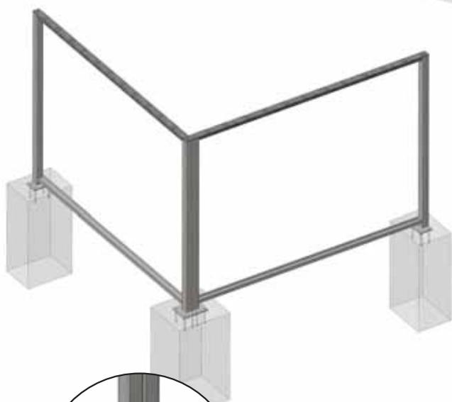
*Positionnement de deux modules pour la réalisation d'un angle avec platine spécifique\**
