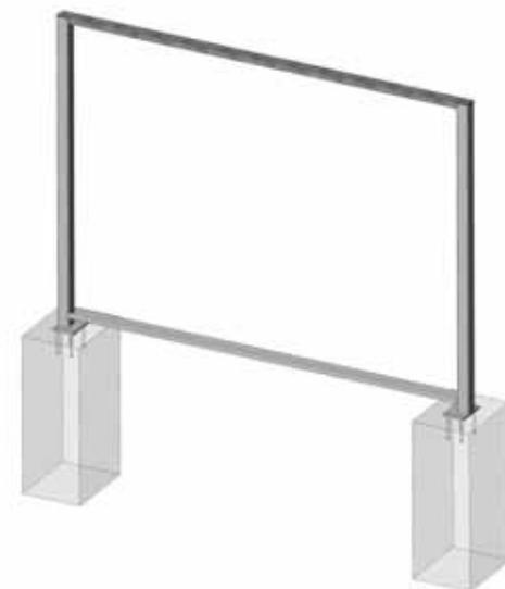
*Fixation sur plots béton*
